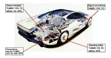
Slika: Potencijalna primena kompozita na osnovi titana kod šasije automobila. Figure: Potential application of titanium-MMC alloys for chassis components.
