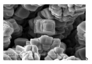
Slika: SEM mikrofotografije čestica bakarnog praha dobijenih reversnim režimom elektrolize. Odnos katodnog i anodnog vremena 2.5. Vreme katodnog taloženja 1s. Vreme anodnog rastvaranja 0.4s. Katodne (anodne) amplitudne gustine struje i srednje gustine struje: a)  $j_k=j_a=24 \text{ A/dm}^2$ ,  $j_{sr}=10.28 \text{ A/dm}^2$ ; b)  $j_k=j_a=30 \text{ A/dm}^2$ ,  $j_{sr}=12.85 \text{ A/dm}^2$ .
