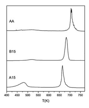
Figure: Rezultati TPD merenja, dobijenih pri konstantnoj brzini zagrevanja od 5 K/min, u temperaturskom opsegu od sobne temperature do 973 K, komercijalnog uzorka  $MgH_2$  (AA) i uzoraka  $MgH_2$  bombardovanih jonima  $B^{3+}$  energije 45 keV (B15) i  $Ar^{8+}$  energije 120 keV (A15), fluence  $10^{15}$ jona/cm.
